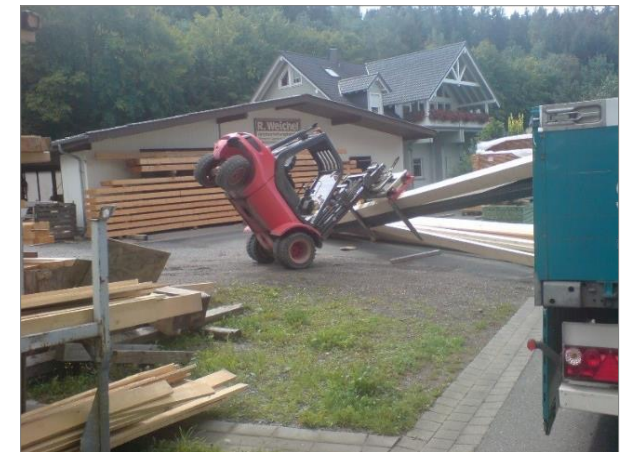
Das kann beim Fahren mit hoher Last passieren!
