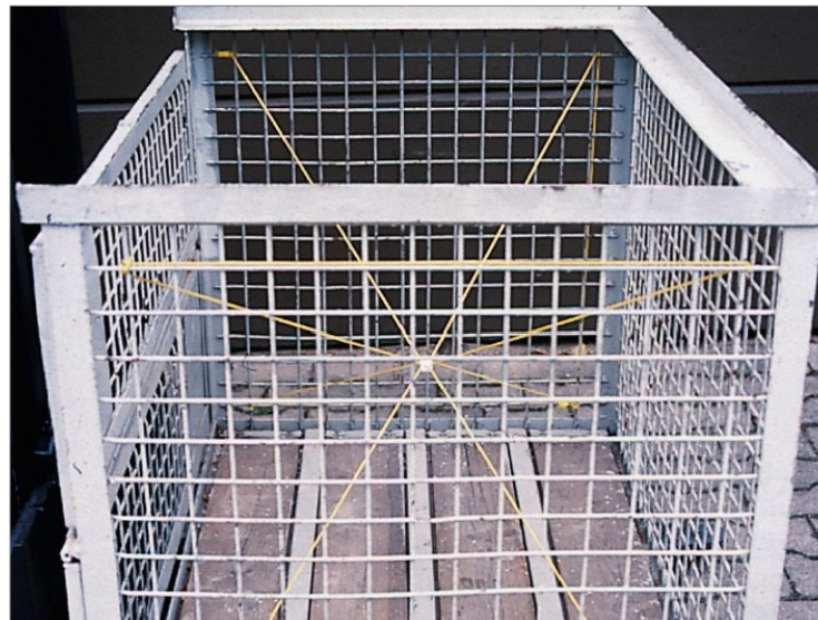
Schwerpunkt einer (angenommen) gleichmäßig gefüllten Gitterbox.
