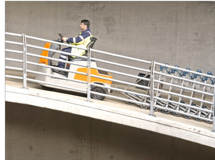
Hier zieht die angehängte Last den Schlepper bergab (= hangabwärts).
