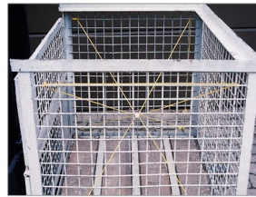
Schwerpunkt einer (angenommen) gleichmäßig gefüllten Gitterbox.
